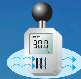
日向では計測器自体が熱くなりやすく、正確な温湿度を計測するには、計測器内部に熱をこもらせないように、常に外気を取り入れるための通気口が必要となります。
